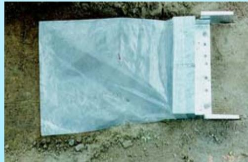
Aparelho Coletor de Erosão
