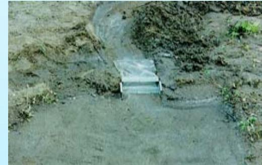
Aparelho Coletor de Erosão
